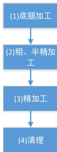
图 1.2 壳体加工生产工艺流程图
