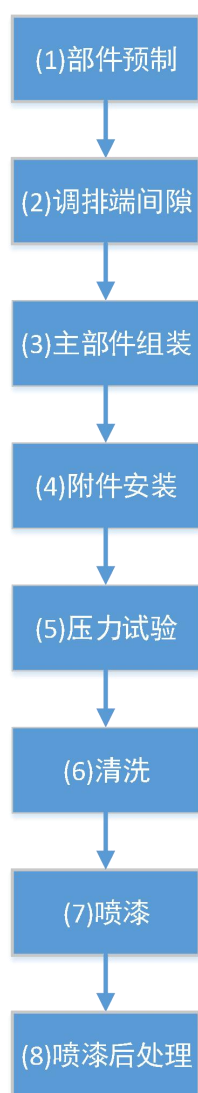
图 1.3 压缩机装配工艺流程图
